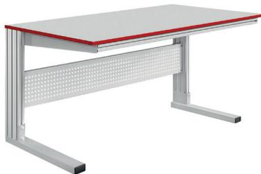
Стол базовый СПБ-КП изготовлен из конструкционного анодированного профиля 45х45 мм. Конструкция стола не предназначена для размещения верхнего навесного оборудования.
