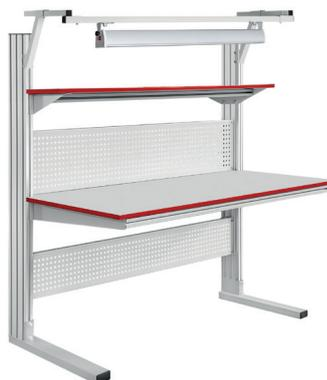
Стол СПД-КП изготовлен на базе конструкционного анодированного профиля 135x45 мм. Основным преимуществом серии столов СПД-КП является наличие пазов в конструкционном профиле, с помощью которых может быть изменена конструкция стола исходя из текущих производственных задач.
