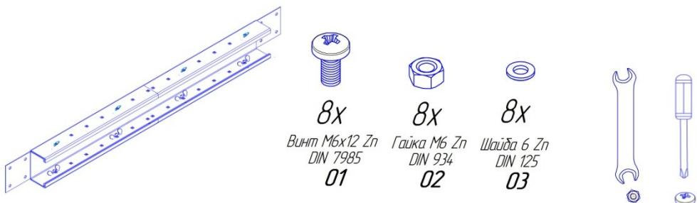
Траверса поставляется в собранном виде. Комплект крепежа монтажный необходим для соединения Траверсы с Опорами WOKER (в горизонтальной или вертикальной плоскости). Для Верстаков длиной 1000 мм разбирать Траверсу WOKER не нужно. Для других Верстаков необходимо, открутив гайки-барашки М6, извлечь декоративные болты М6, и, перемещая вправо и влево швеллеры Траверсы, совместить отверстия на них и на неподвижной части, добившись необходимой длины траверсы (L), собрать ее обратно.
